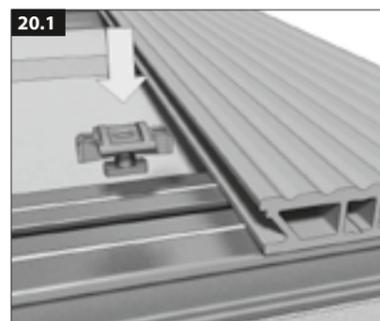
Die Montageclipse in die UK-Profile einsetzen, drehen und über die untere Dielenkante einschieben.
